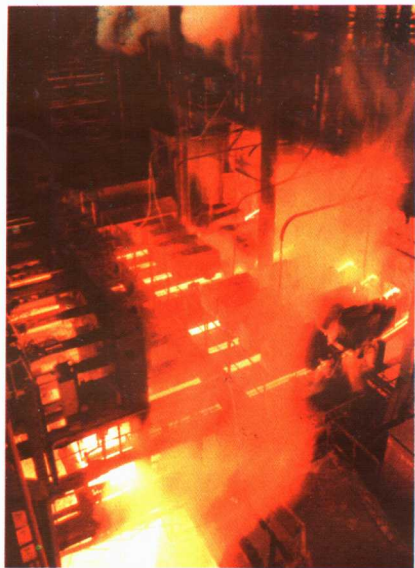
■ 热和相变——首钢公司的八流连铸生产线
