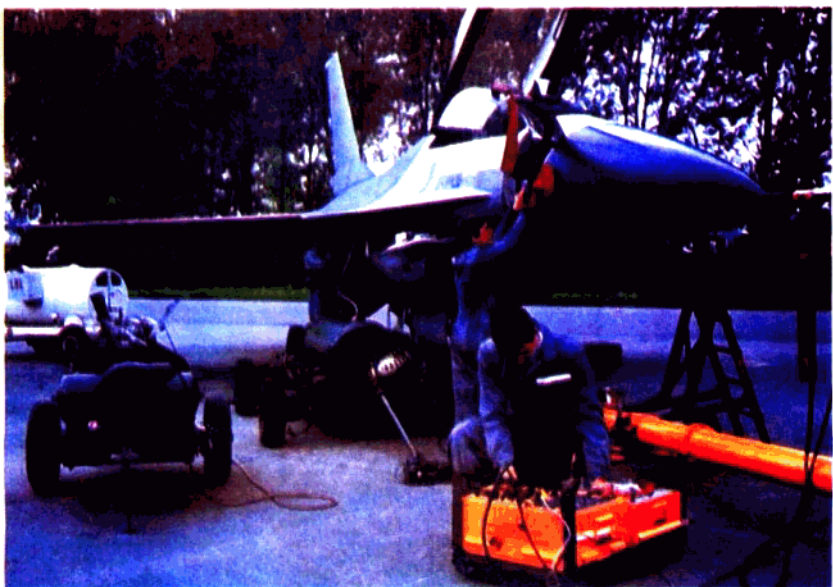
地勤人员检测机载电子设备 ▼
