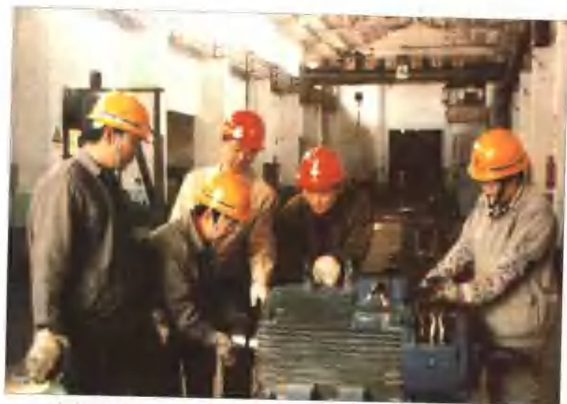
电修车间主要承担莱钢的交。直流电动机，变压器和电焊机的修理。大电机和大容量变压器的安装。试验任务
