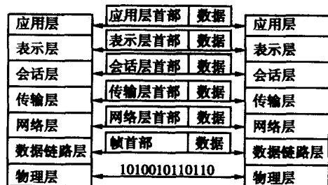
图 1.5 当数据从层 1 向下穿过各功能层时,数据的前方被不断地套上穿过各层的首部
