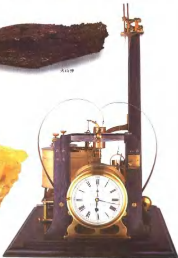
公元1863年制造的格雷-米尔思式地震仪
