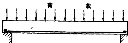
图 1-2 钢筋混凝土梁受力示意图
