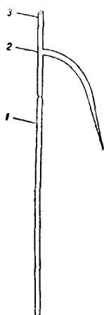
圖 3 帶有为抽气与灌水銀用的三通管的內管 1. 內管， 2. 三通管， 3. 与真空裝置焊接的地方。
