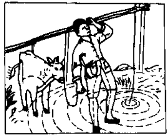
图 1-3 跨步电压触电
