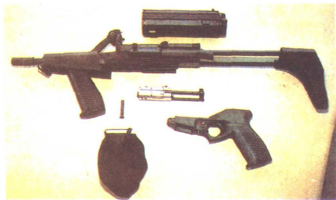
美国“卡利科” 9毫米M960A 型冲锋枪分解图
