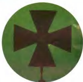
示范阴极射线形成马尔他十字型辉光的模型
