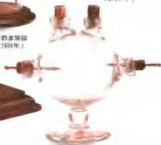
水的电解实 验中所用的 电量计（公 元1807年）
