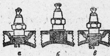
图 9-5 火花塞在汽缸中的正确位置和不正确位置
