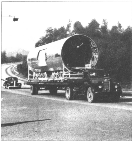
一个预制的炸弹舱用卡车运往位于西雅图的装配工厂。
