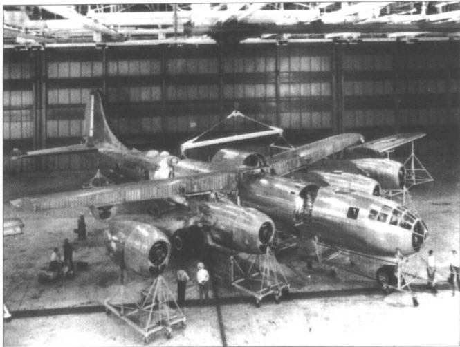
一家工厂的 B-29 的实物模型展示其主要部件是如何设计集合在一起的。
