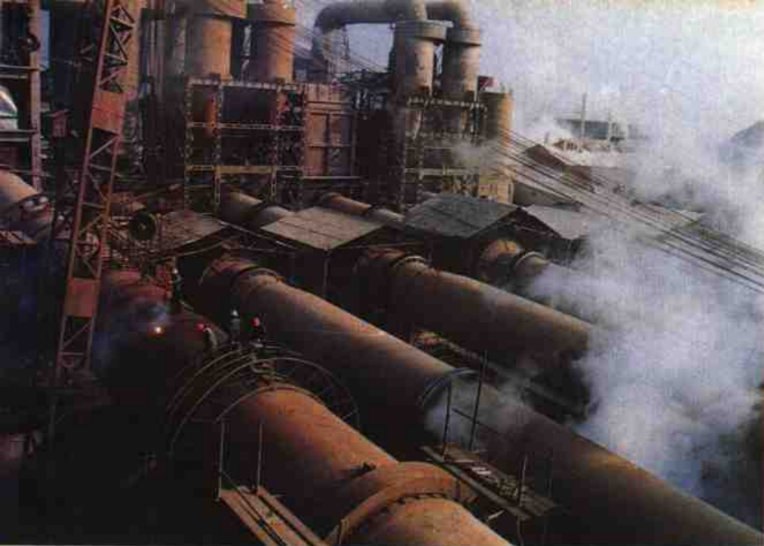
1988年建成的日产 熟料1280吨的氧化铝六 号熟料窑
