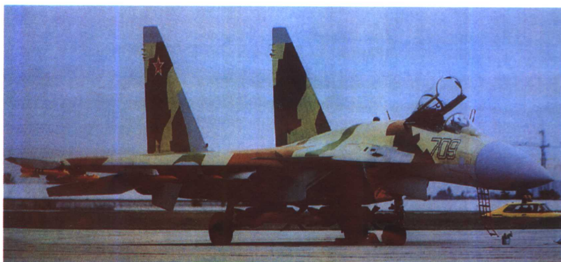
苏-35可以清楚的看到机翼前的鸭式小翼
