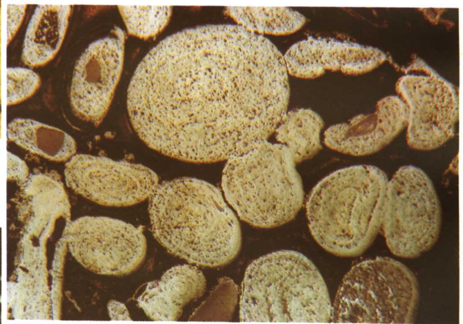
d. 鲕状构造：鲕粒为赤铁矿 反光
