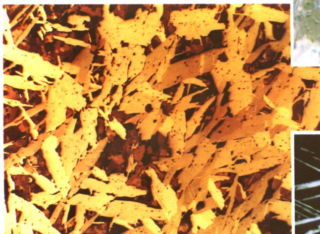
c. 镜铁矿(浅褐)、铁白云石(深褐)呈叶片状结构 反光, 斜交
