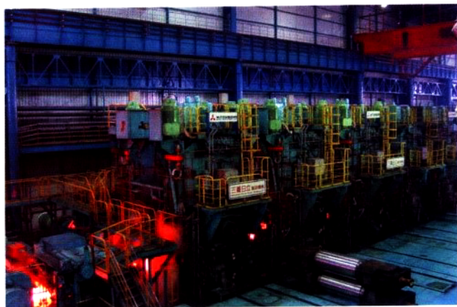
中国唐山钢铁股份有限公司热轧薄板厂 薄板坯连铸连轧生产线精轧机组
