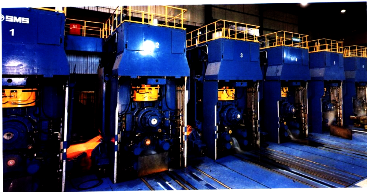
西马克公司为德国蒂森－克虏伯公司提供的薄板坯连铸连轧设备——精轧机组
