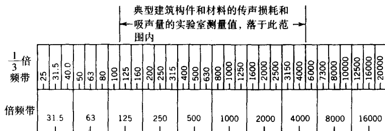
图 1.5 为了方便测量和分析, 将可听频率范围划分为标准倍频带和 1/3 倍频带。许多建筑组成部分的实验室测量标准声学性能频带的中心频率在 100 ~ 4000Hz 范围之内。(选自建筑百科全书: 设计、工程及建筑, William J. Cavanaugh, "Acoustics-General Principles", Joseph A. Wilkes, Ed. 版权 © 1988 John Wiley Sons. 经 John Wiley & Sons 同意再版。)
