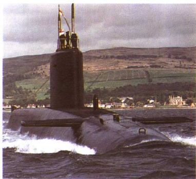
上图：“决心”号弹道导弹核潜艇，1966年下水，艇上载有“北极星”弹道导弹。
