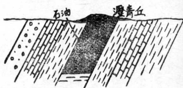
圖4 油砂岩露出地面(2)
