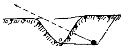
图 3-4-33 控制抛掷方向的辅助药包
