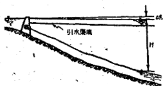
图 2-2 明渠开敞式电站 枢纽剖面示意图
