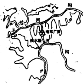
图 2-6 电站枢纽布置示意图
