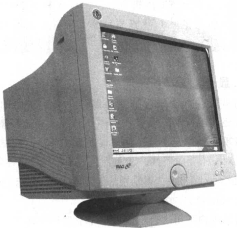
图 1-2-1 传统CRT显示器的可视角度可达 180^\circ
