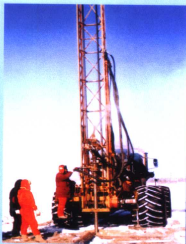
黑龙江汤原工区利用反循环钻具，解决流沙砾石区地震钻井下药难的问题，钻井深度可达30米
