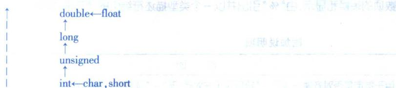
上图中向左的箭头表示必定的转换,如 char 型和 short 型必定转换为 int 型,float 型在运算时先转换为 double 型(即使是两个 float 型相加,也都先转换成 double 型,然后再相加)。向上的箭头表示当运算对象为不同类型时的转换方向。
