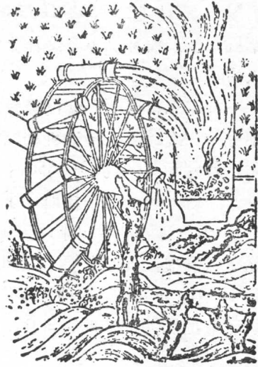
图 5 我国的水转筒车
