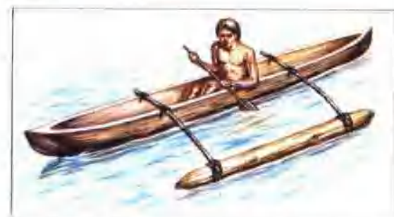
▲ 獨木舟 在鑿船上設置突出於側面的橫木，然後在橫木末端綁上木頭以幫助穩定。在現今南太平洋島嶼間，仍還使用着這種獨木舟。
