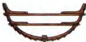
▲ 拼合船 利用木材或木片拼合成的木船。在裝配船出現以前，這種形態的船到處都可以看到。
