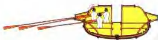
▲三段加力船的剖面圖。通常是以奴隸擔任划船手，坐的地方分成兩層。
