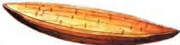
▲ 拼合船 利用木材或木片拼合成的木船。在裝配船出現以前，這種形態的船到處都可以看到。
