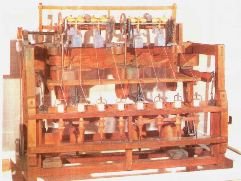
▲ 阿克莱特发明的水力纺纱机 比起织布机的发展,纺纱机显得比较缓慢,但这种纺纱机给纺织业带来了革命性的进步
