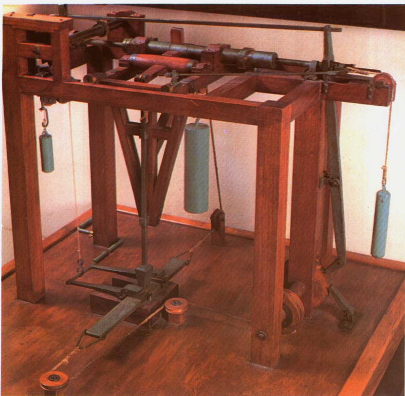
▲ 配有自动装置的锻造锤 达·芬奇在研究机械装置时,时常构想现代的自动装置
