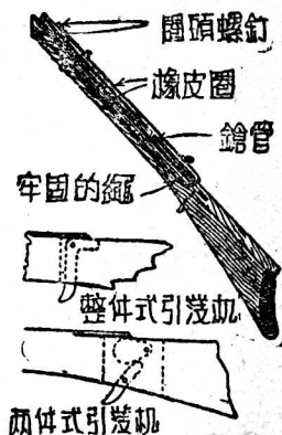
圖2 玩具步鎗和它的二種引發機的構造。
