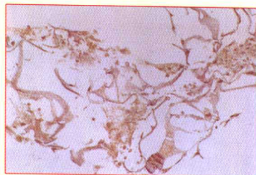
图2 双层壳聚糖 / 明胶 / 透明质酸支架 SEM 显微照片
