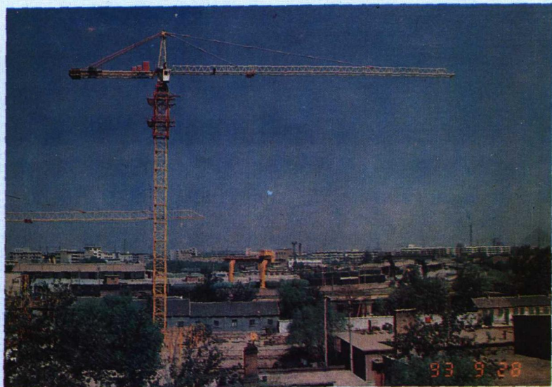
建设机械研究所设计研究的 QTZ100 塔式起重机，已在建筑施工中应用。
