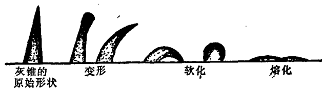
图 2-1 测定灰熔点时灰锥的各种状态
