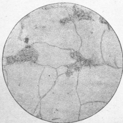
圖 2 10号鋼於退火状态下的 显微組織。×500
