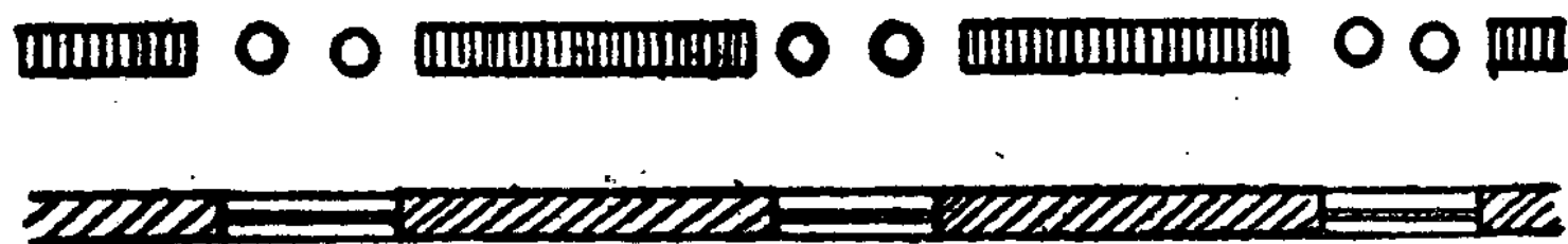
6—2 一般砌至門窗洞的區域佈置圖 圖 6. 砌牆工作區域平面佈置圖
