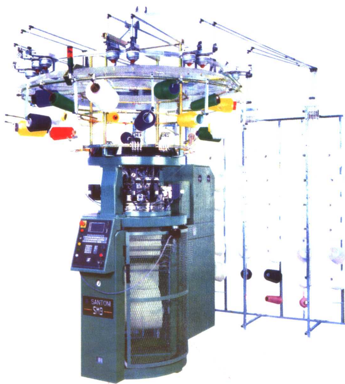
图 9 电脑控制圆型纬编针织机 (样本)
