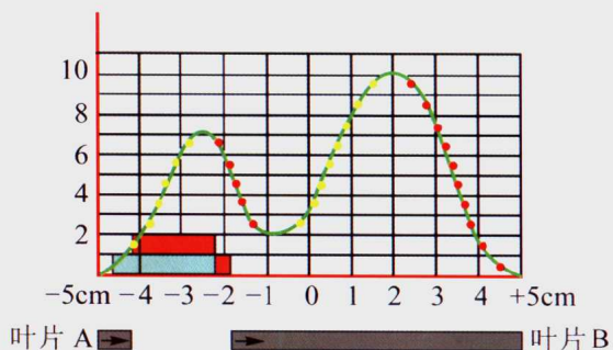
图 1-11D MLC 动态调强第二 阶段照射示意图
