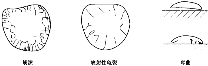
图 1-11 安定性不合格的试饼
