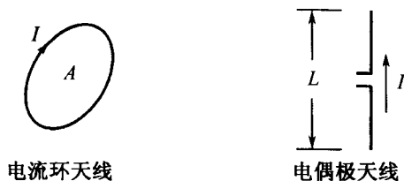
图 1-3 基本天线结构
