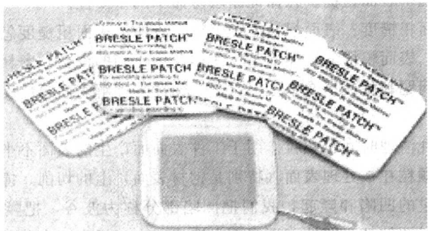
图 2-4 测定表面上残留的可溶性盐类浓度的贴片和注射用针 (图片来源：ELCOMETER 公司)
