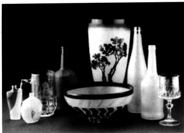
图 1-2 经喷丸处理后的玻璃制品 (图片来源: GUYSON 公司)
