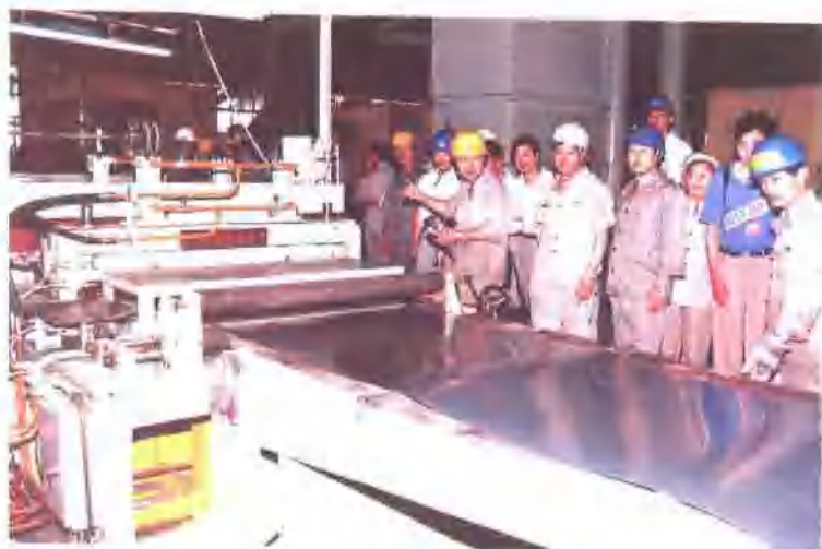
机械制造公司 自行设计制造的国内首台薄板激光焊机试制成功
