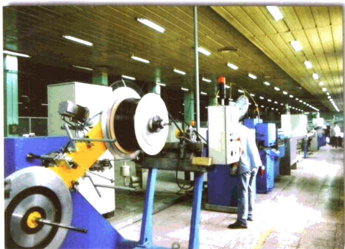
薄壁内镶式滴灌带生产线
