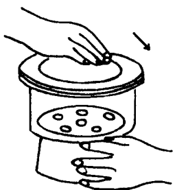
图 1-6 干燥器的开启和关闭
