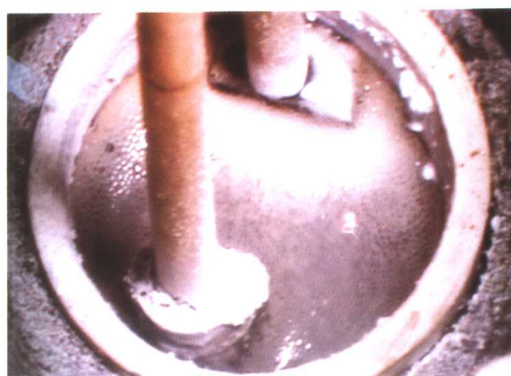
彩图 16 300A 惰性阳极电解时产生氧气
