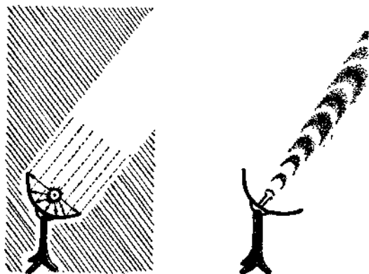
图 2 探照灯的光束(左)和雷达的无线电波束(右)
