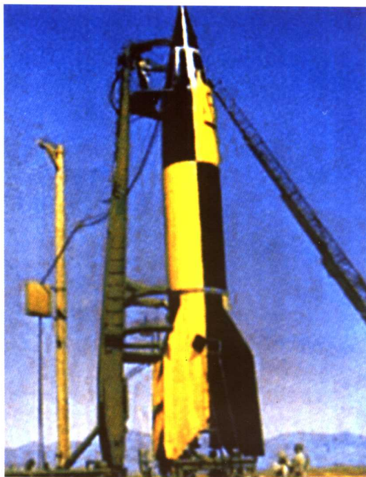
V-2型飞弹就是用液体燃料推进的火箭,这种火箭能飞行数千公里
