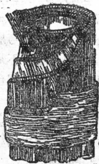
圖3 針葉樹種細胞壁結構的圖式
