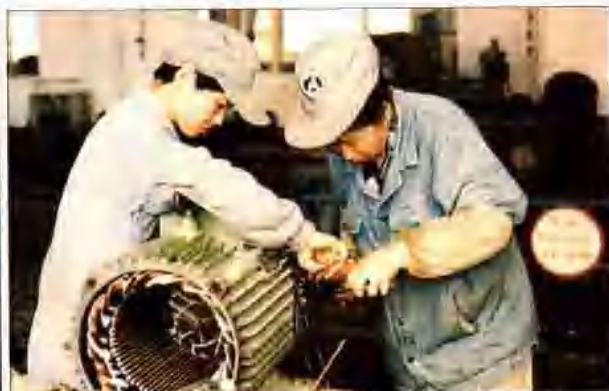
机修车间职工正在维修电机
