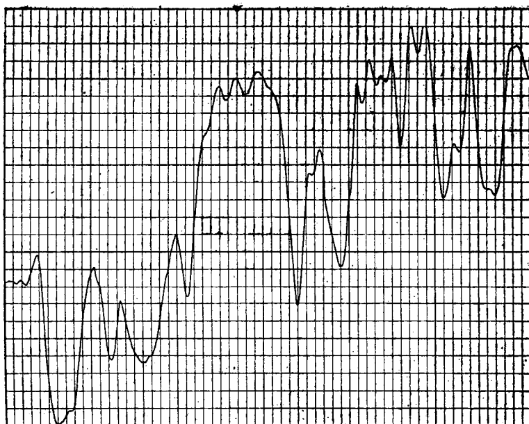
图 4 感应测井曲线原图
