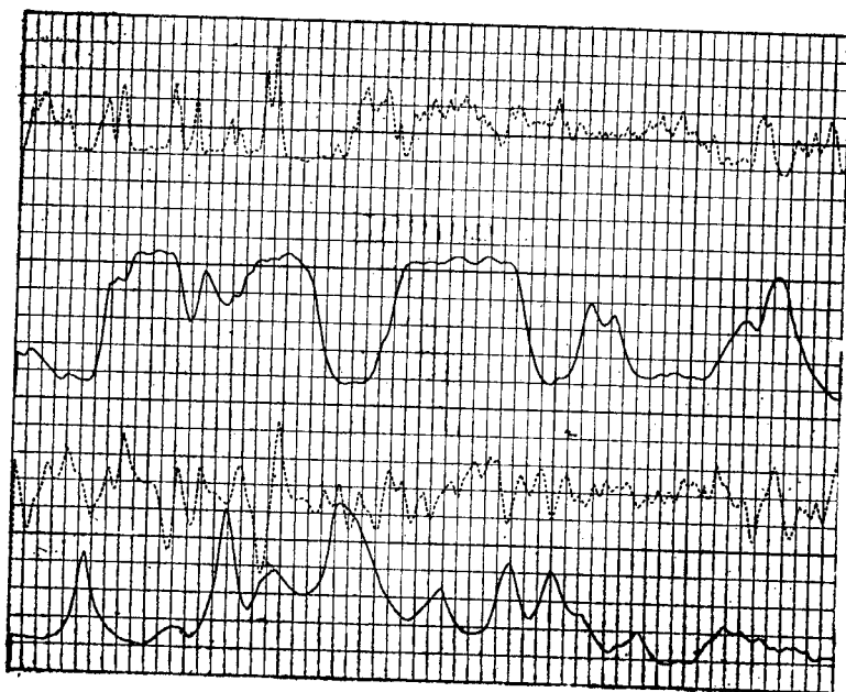
图 6 0.5 米电位、声波、自然电位井径测井曲线原图
