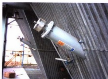
SQ-160G型声波清灰器用于电除尘器灰斗出口清灰、清堵
