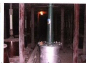
SQ-75型声波清灰器在顶部电磁振打电除尘器增效改造中的应用
