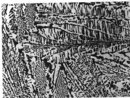
图 1-15 低温莱氏体显微组织结构
