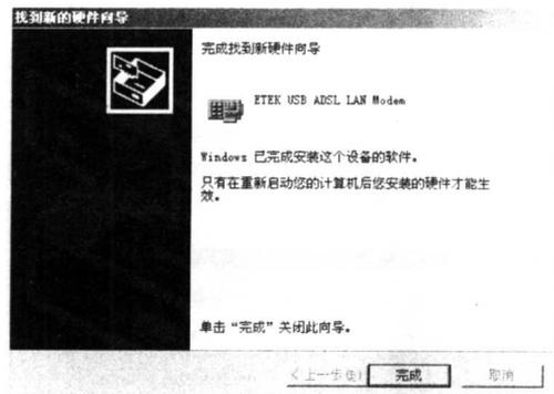
(5) 在开始菜单程序组中选择 “ETEK ADSL”, 按 “config”, 在弹出窗口中选择 “setting”, 把 VPI 与 VCI 分别设为 “8” 与 “35”。重启完成驱动程序安装过程。
